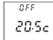
Betriebsmodus OFF Thermostat ausgeschaltet
